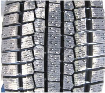
Рис. 13. Участок протектора фрикционной шины «YOKOHAMA ice GUARD IG 20 145/80 R 13» (стрелками отмечены ламели)
